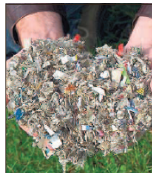
Der Rohstoff: Ersatzbrennstoffe werden in der Anlage verarbeitet.
