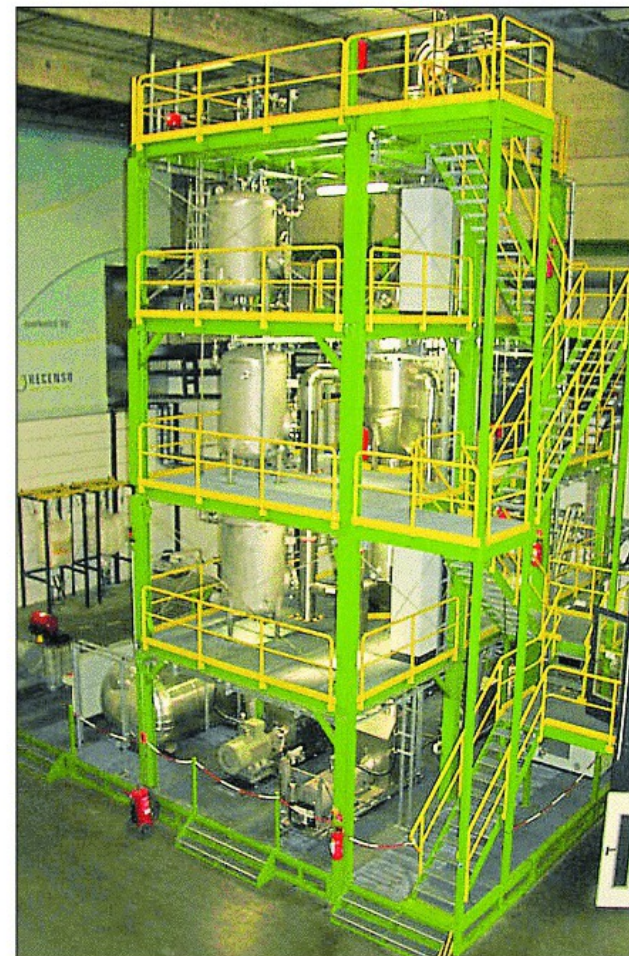
Aufbereitete Haus- und Gewerbeabfälle , die unter anderem in der Zementindustrie als Ersatzbrennstoff eingesetzt werden, können auch zu Heiz- und Kraftstoffen veredelt werden. Bisher fünf Millionen Euro wurden in Ennigerloh in die bundesweit erste Anlage investiert, in der das Verfahren der sogenannten Katalytischen Drucklosen Verölung in industriellem Maßstab angewendet wird. Etwa 5 Millionen Liter Kraftstoff pro Jahr soll die Anlage einmal aus 10 000 Tonnen Abfallstoffen erzeugen.
