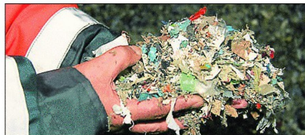
Aufbereitete Haus- und Gewerbeabfälle , die unter anderem in der Zementindustrie als Ersatzbrennstoff eingesetzt werden, können auch zu Heiz- und Kraftstoffen veredelt werden. Bisher fünf Millionen Euro wurden in Ennigerloh in die bundesweit erste Anlage investiert, in der das Verfahren der sogenannten Katalytischen Drucklosen Verölung in industriellem Maßstab angewendet wird. Etwa 5 Millionen Liter Kraftstoff pro Jahr soll die Anlage einmal aus 10 000 Tonnen Abfallstoffen erzeugen.
